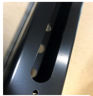
写真2. 電着塗装した部品
