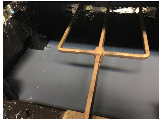
写真1. 電着の塗料槽の様子
